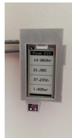
Abbildung 2: ESP32 mit integriertem E-Ink und einem Sensor für Umweltdaten
