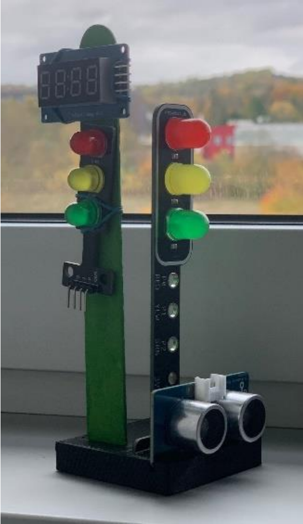
Abb. 2: Für die Ampelanlage wurde ein Ständer konstruiert und gedruckt, an dem die Ampeln mit dem Display und dem Ultraschallsensor montiert werden können.
